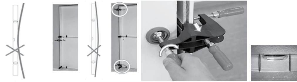
**D** Sollte eine oder beide Funktionen nicht gegeben sein, justieren Sie mit Hilfe der Zargenrichtzwingen und der Luftkissen die Schließseite nach.
